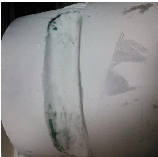
図 8. ガウジング部の写真 (PT 現像スプレー適用)
